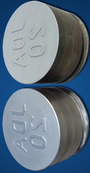
Carbidbeschichtung Prägestempel - 7fache Standzeiterhöhung
