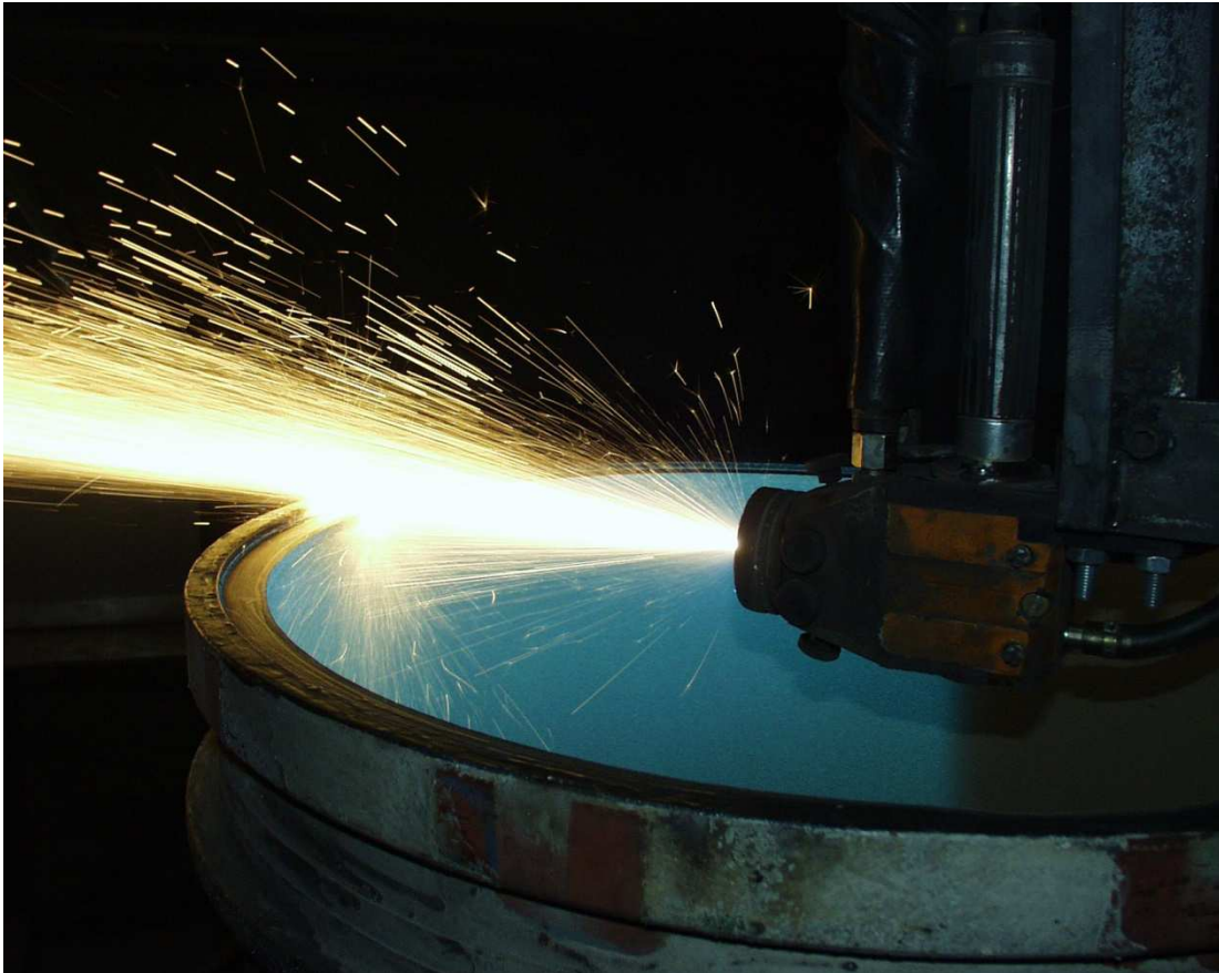
ein Gehäuse innen Beschichten mit einer Lagerlegierung bero-arc alloy 60-130
