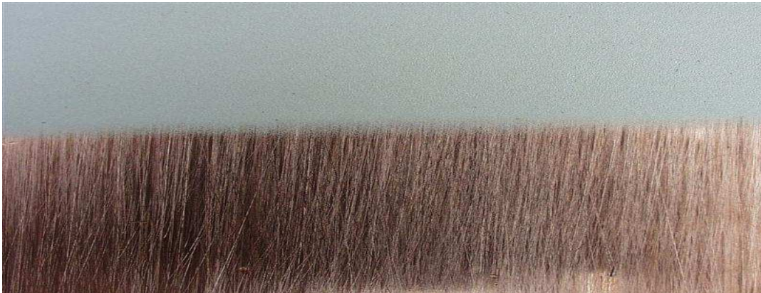
Abbildung: kaltgasespritzte Silberschicht auf Kupfer – ohne Sandstrahlvorbereitung
