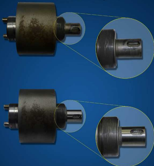
Lagerstelle regeneriert vorher - nachher im Vergleich
