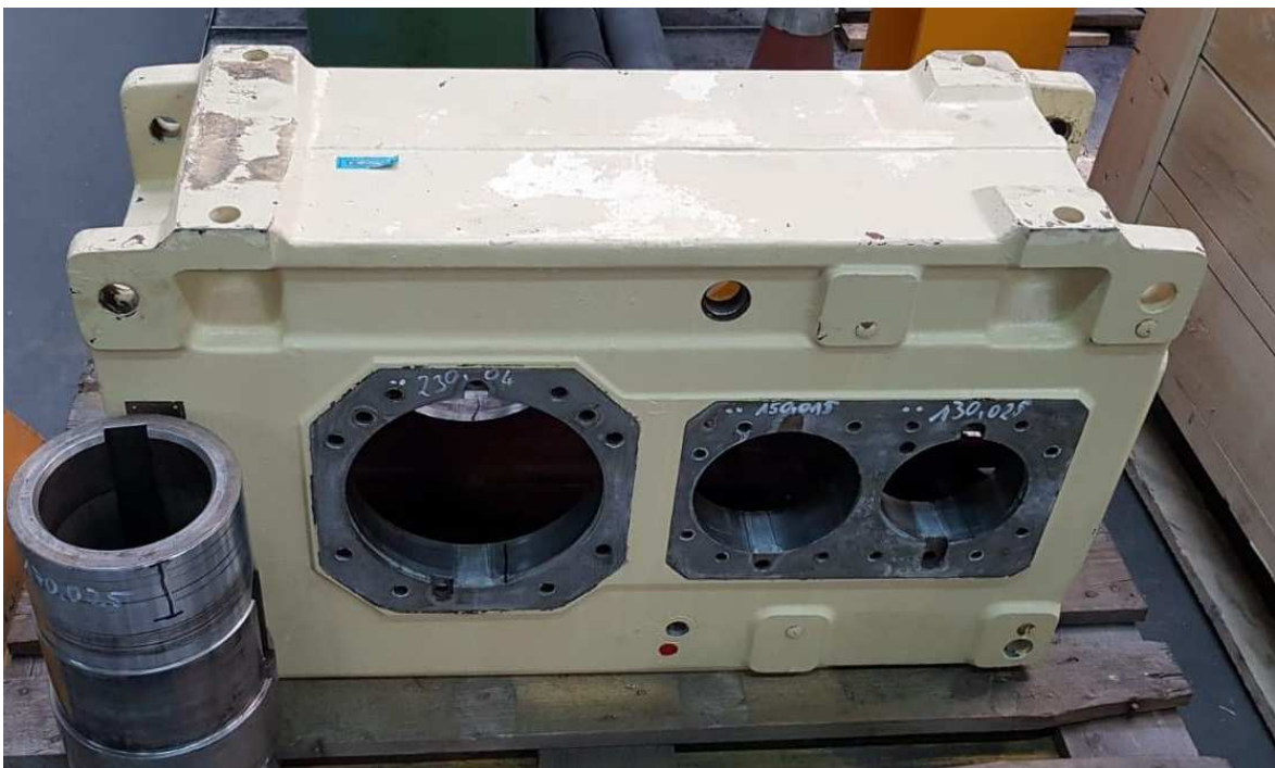
Getriebegehäuse mit mehreren Lagersitzen zur Regeneration
