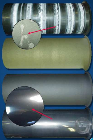
verschlossene Keramikschicht - entfernt und erneuert
